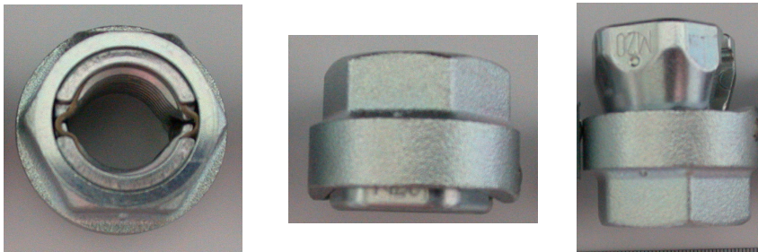
Bild 1: Übersicht der geprüften Mutternabmessung M20 x 2,5
